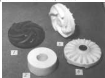
Рисунок 17. Металлополимерные рабочие колеса центробежного насоса: 1 – рабочее колесо насоса из АТМ-1; 2 – исходная заготовка из Ф-4 для штамповки колеса насоса; 3, 4 – металлофторопластовые рабочие колеса, полученные объемной штамповкой
