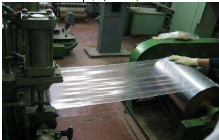
Рисунок 5. Фотография конечного этапа получения поливинилхлоридной пленки, модифицированной Fe/C НК (0,0008%).
